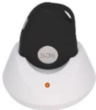
Avant la première utilisation, posez *Nirbi lite 2* sur sa base, elle-même reliée au chargeur secteur avec le câble USB. Une recharge complète dure environ 3 heures. La recharge peut être effectuée à tout moment, que la batterie soit complètement vide ou pas. Compte-tenu de la grande autonomie de *Nirbi lite 2*, il est judicieux d'effectuer la recharge uniquement à réception de l'alerte de batterie faible.
